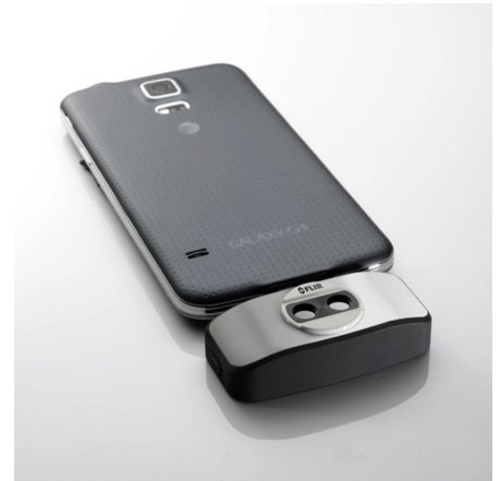
Ábra 21.3 2015: FLIR One, egy iPhone-ra és Android készülékre csatlakoztatható tartozék. Tömege: 90 g.
