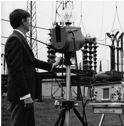
Ábra 21.2 1969: Thermovision 661. modell. A kamera körülbelül 25 kg tömegű volt, az oszcilloszkóp 20 kg, az állvány pedig 15 kg. A kezelőnek szüksége volt még egy 220 VAC generátorra és egy 10 literes, folyékony nitrogént tartalmazó palackra. Az oszcilloszkóp bal oldalán egy Polaroid tartozék (6 kg) látható.
